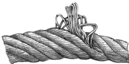
Корзинообразная деформация каната
