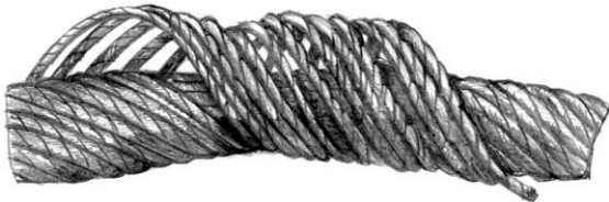
Корзинообразная деформация каната
