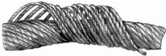
Корзинообразная деформация каната
