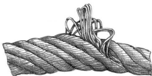
Корзинообразная деформация каната
