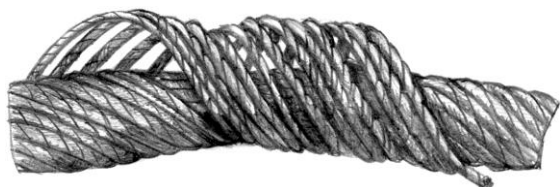
Корзинообразная деформация каната
