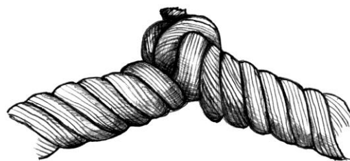
Корзинообразная деформация каната
