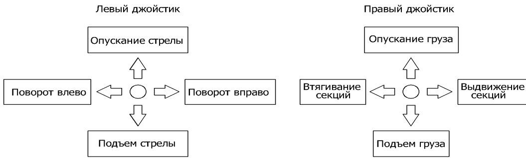
Рисунок 1.9 Схема рабочих движений джойстиков
