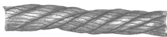
Местное уменьшение диаметра каната
