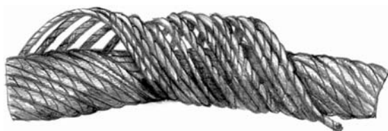
Корзинообразная деформация каната
