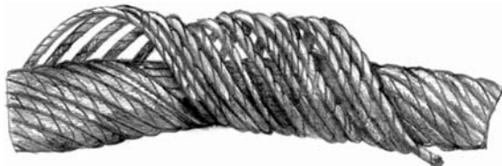
Корзинообразная деформация каната
