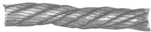
Местное уменьшение диаметра каната
